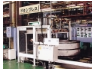
土管とシリンドラーを組み合わせた手製プレス機「ドカンプレス」
