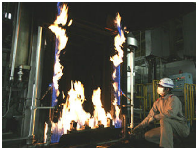
熱処理工業炉の切替作業
