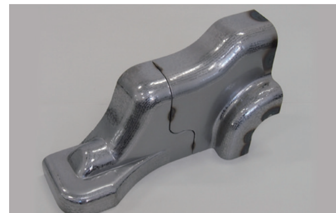
銅賞を受賞した自動車板金課題作品 一枚の鉄板から作業時間(7時間)内に課題図面の指示通りに作り上げます
