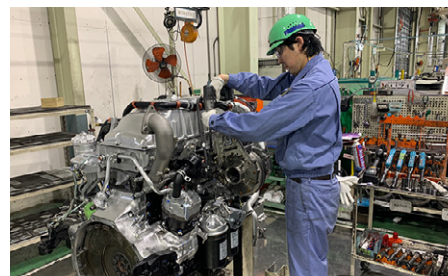
再組立て中のリビルトエンジン
