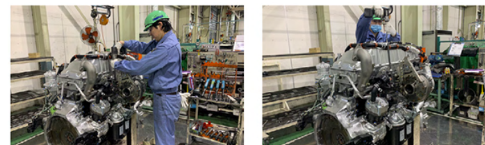
再組み立て中のリビルトエンジン
