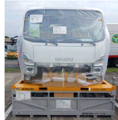
キャブ用リターンラック (オレンジ) + 部品用リターンラック (グレー)
