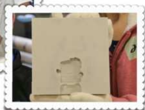
キャラクターの型に砂を込めて鋳型(いがた)を作る
